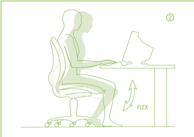
Le mécanisme synchro peut sur option intégrer une translation d'assise avant-arrière ① ainsi qu'un réglage indépendant SYNCHRO-FLEX ② pour une assiette positive de l'assise, adaptée au travail prolongé en position avant.
